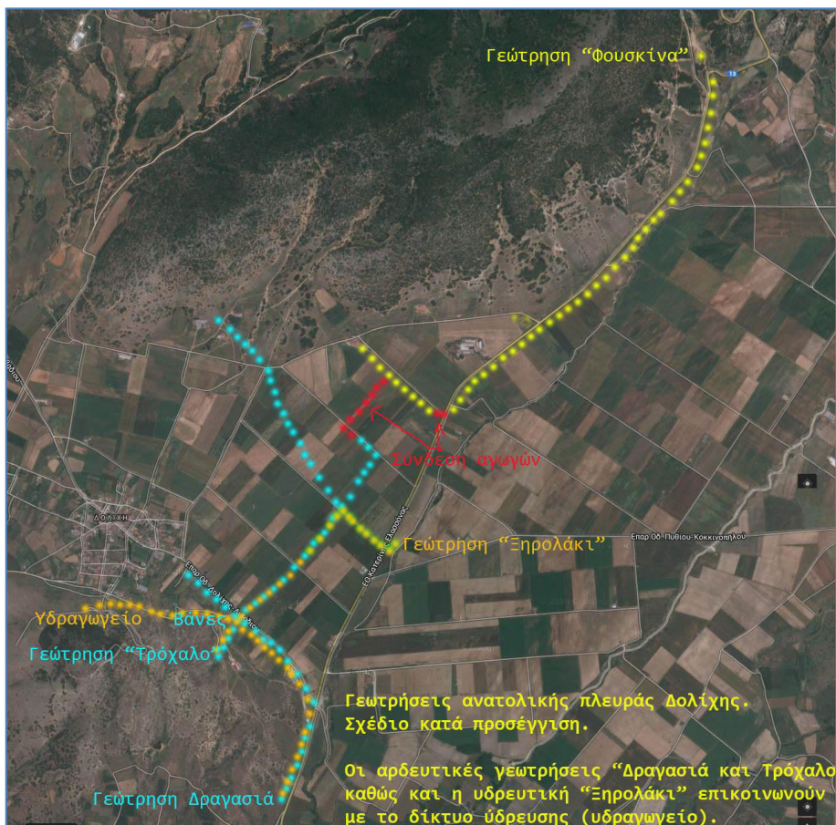
Εικόνα 5: Αποτύπωση γεωτρήσεων και αγωγών άρδευσης ανατολικής πλευράς
